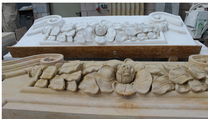
Model a již hotová suprafenestra, která bude zdobit okna v posledním patře paláce, Bamberger Natursteinwerk, Bamberg.
