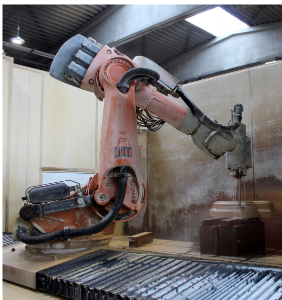
Jeden ze tří frézovacích robotů v Bamberger Natursteinwerk, Bamberg.
